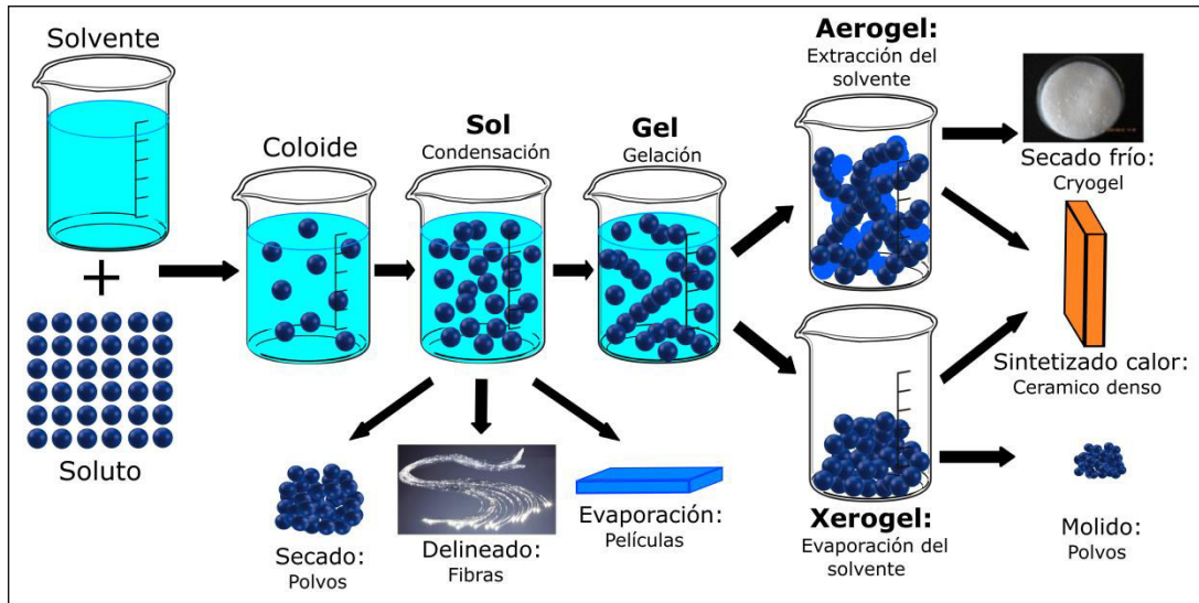
Figura 15. Técnica sol-gel para sintetizar diferentes productos.
