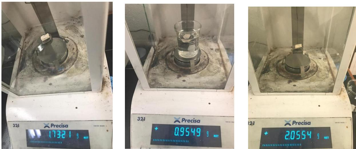
**Figura 4.42.** Pasos para calcular la porosidad de un material ( $W_d$ ,  $W_s$  y  $W_w$  respectivamente).
