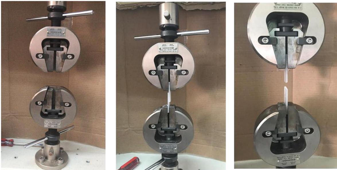
**Figura 4.38.** *Proceso de separación de muestras en la maquina universal. Se observa la prensa, la muestra prensada y la muestra separada.*
