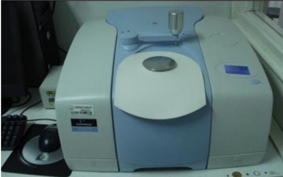
**Figura 3.20.** Espectroscopio FTIR de reflectancia total atenuada (ATR-FTIR)
