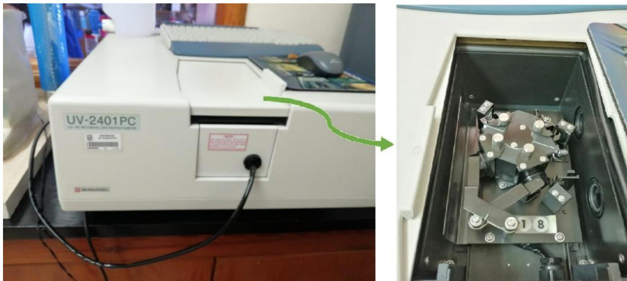
**Figura 3.18.** Equipo de espectrofotómetro UV-Vis, con esfera de integración, en el lado derecho es donde se coloca la muestra
