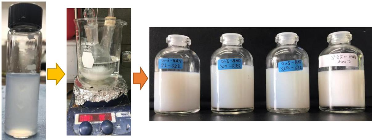
**Figura 4.31.** Incorporación de las nanopartículas en la emulsión y los látex resultantes de PBA, así como los compósitos con diferente porcentaje en peso de las nanopartículas (lado izquierdo, 1%, 0.5%, 0.3% y 0 % respectivamente)
