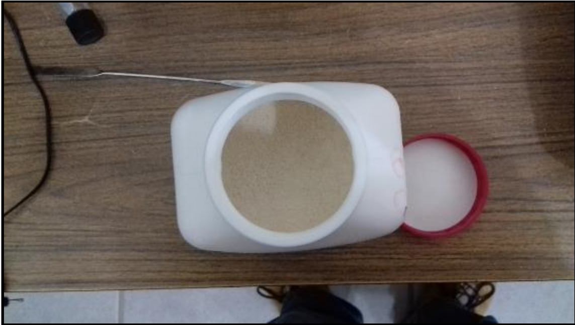
Figura 42. Almacenamiento del polvo en un envase con tapa, el cual fue al refrigerado a 4°C
