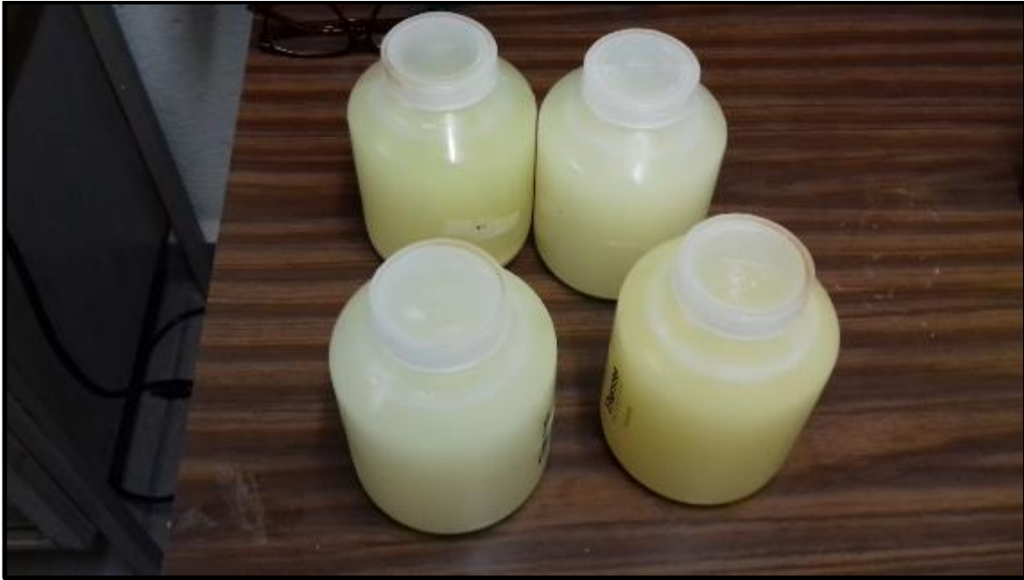
Figura 33. Envases Thermo Scientific® antes de ser centrifugados, los cuatro con el mismo peso para evitar un desbalanceo en la centrífuga
