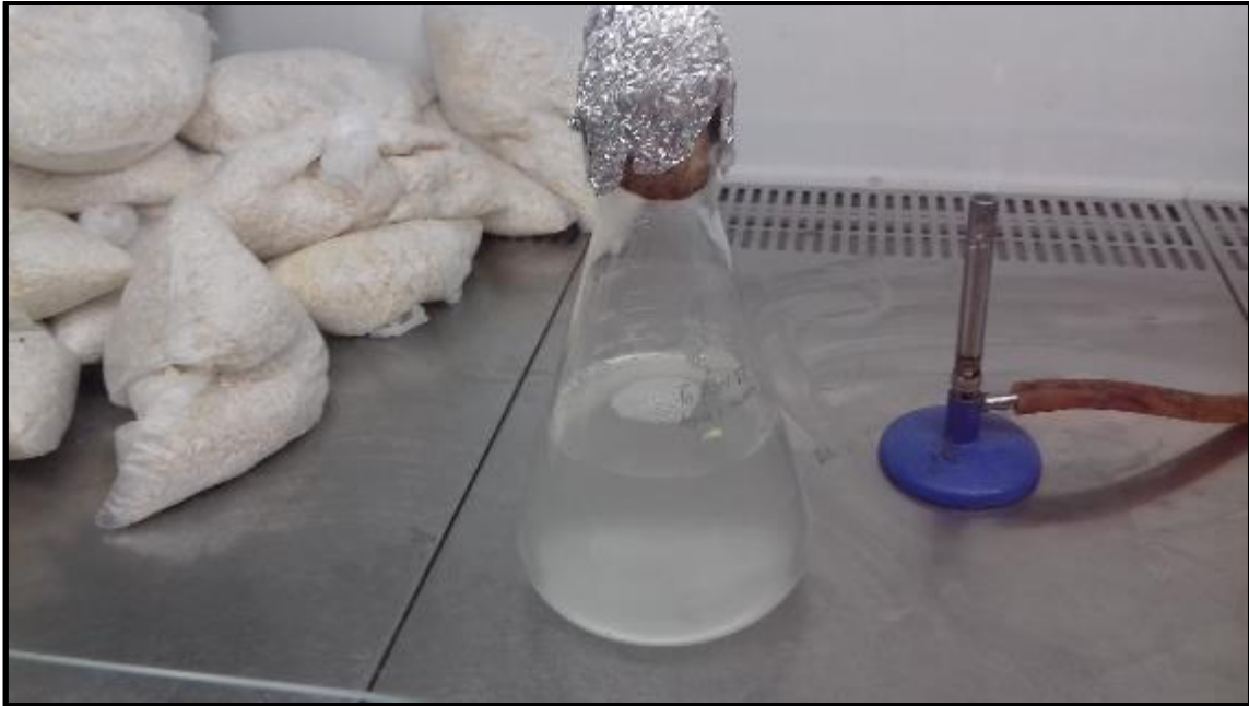
Figura 22. Matraz con solución de agua con Tween y conidios de B. bassiana cepa 6 y al fondo bolsas de arroz estéril, todo ello en una campana de flujo laminar
