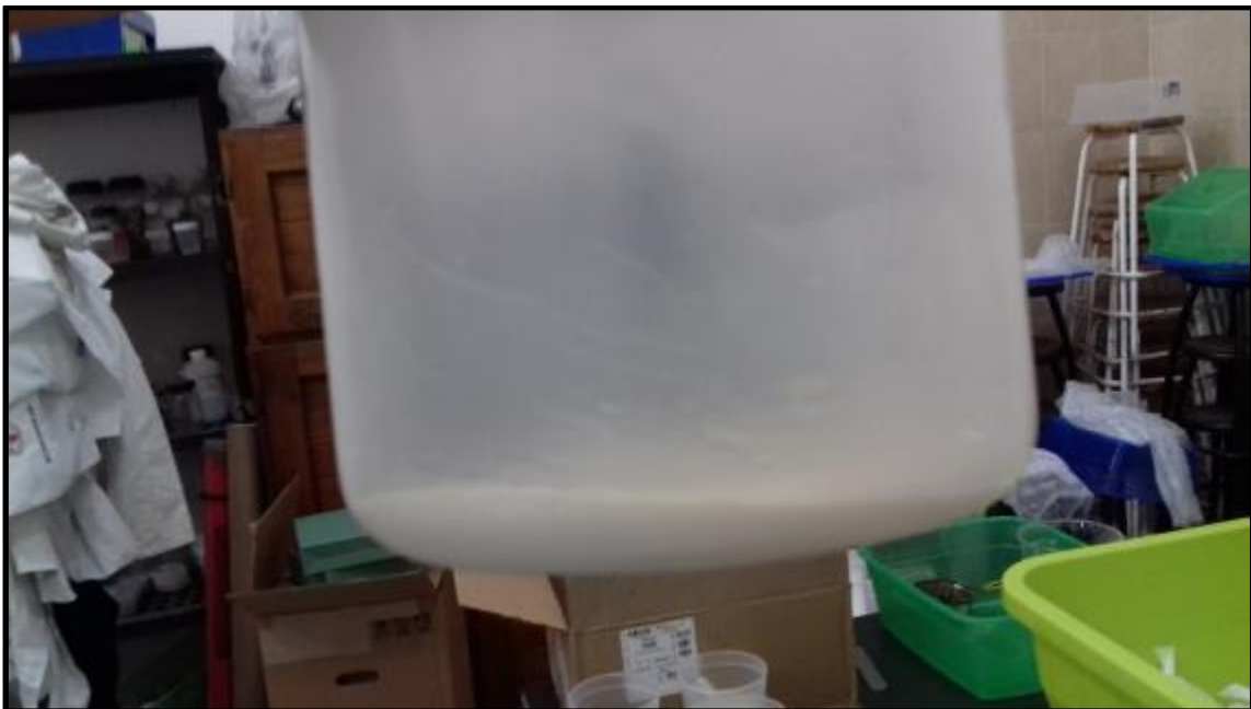
Figura 36. Formación de sedimento en el envase Thermo Scientific® después de la primera lavada y el primer centrifugado
