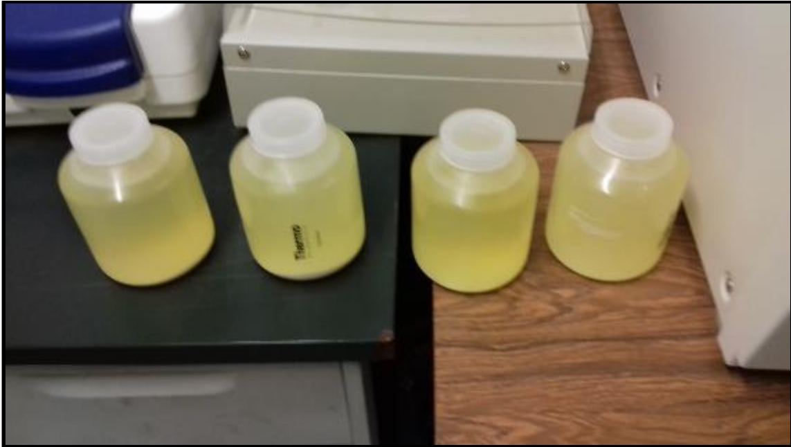
Figura 35. Envases Thermo Scientific® después de ser centrifugados y el líquido amarillo (sobrenadante) volvió a ser empleado en el lavado de más bolsas
