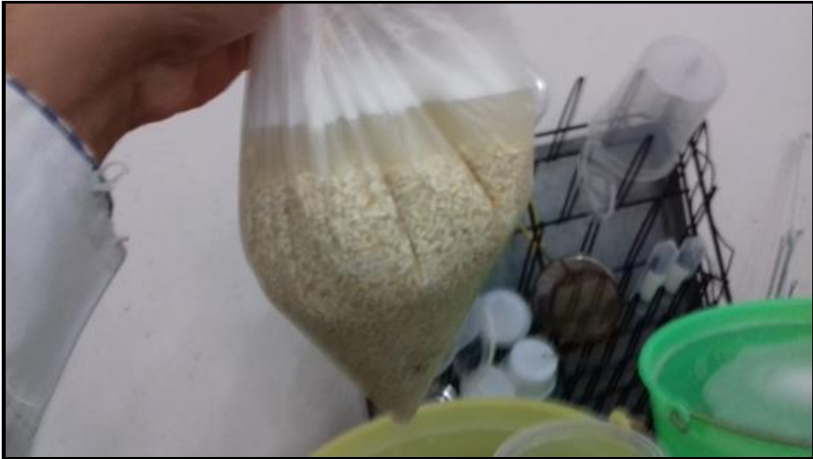
Figura 27. Lavado de las bolsas de arroz con 500 mL de agua con Tween por bolsa para separar los conidios del arroz
