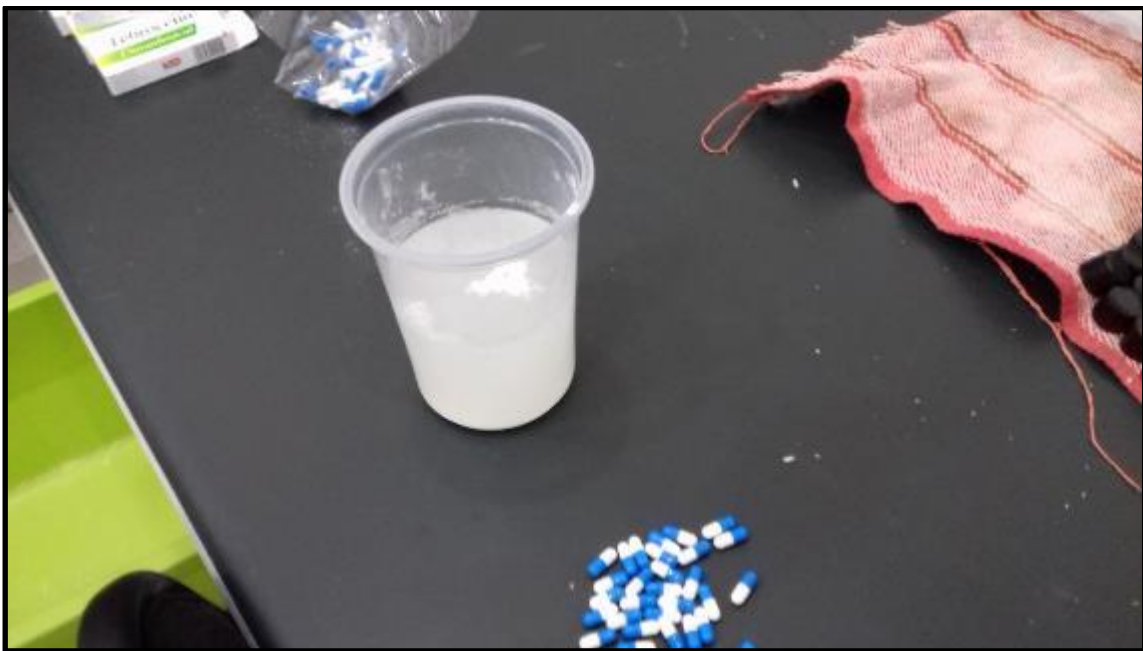
Figura 20. Preparación de solución de cloranfenicol, disolviendo el contenido de las cápsulas en un recipiente con 250 mL de agua
