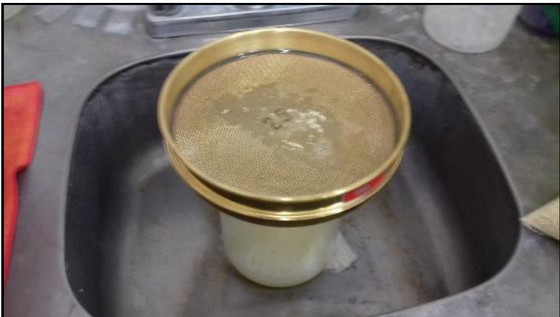
Figura 28. Filtro grueso para impedir el paso de granos de arroz y otras partículas de grosor grande
