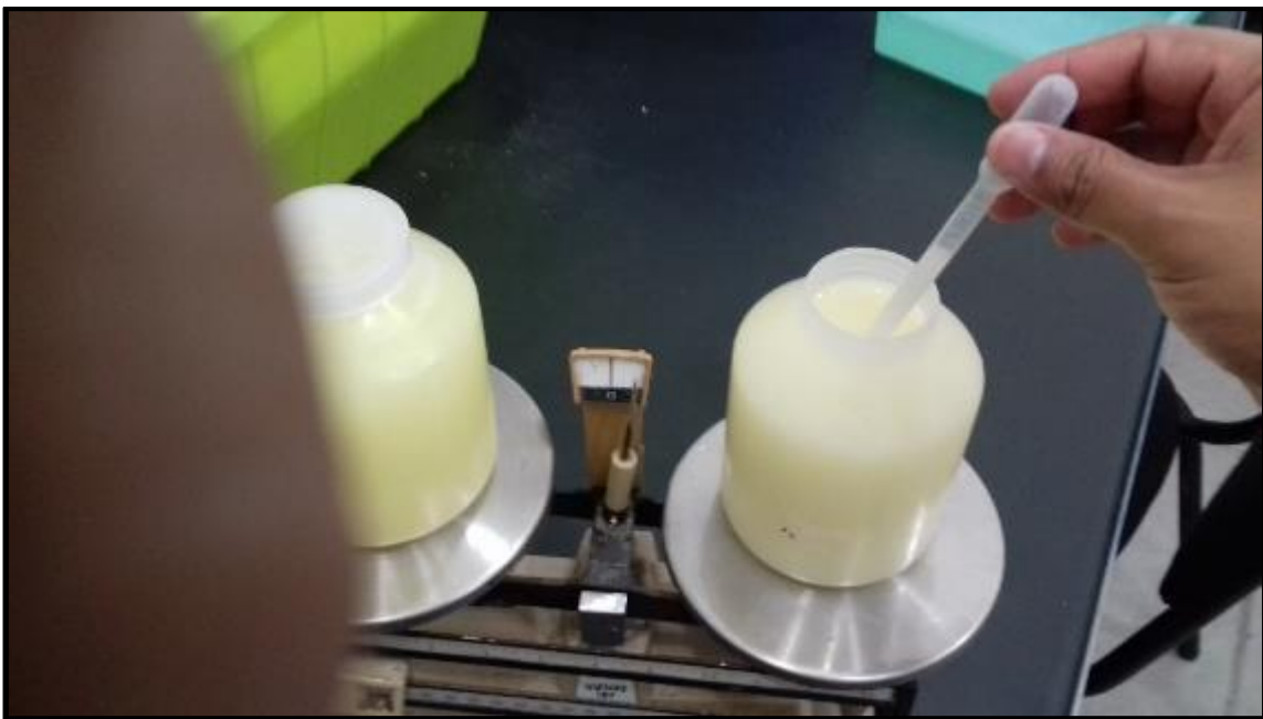
Figura 32. Balanceo del peso de los envases Thermo Scientific® con ayuda de una pipeta de transferencia de 5 mL
