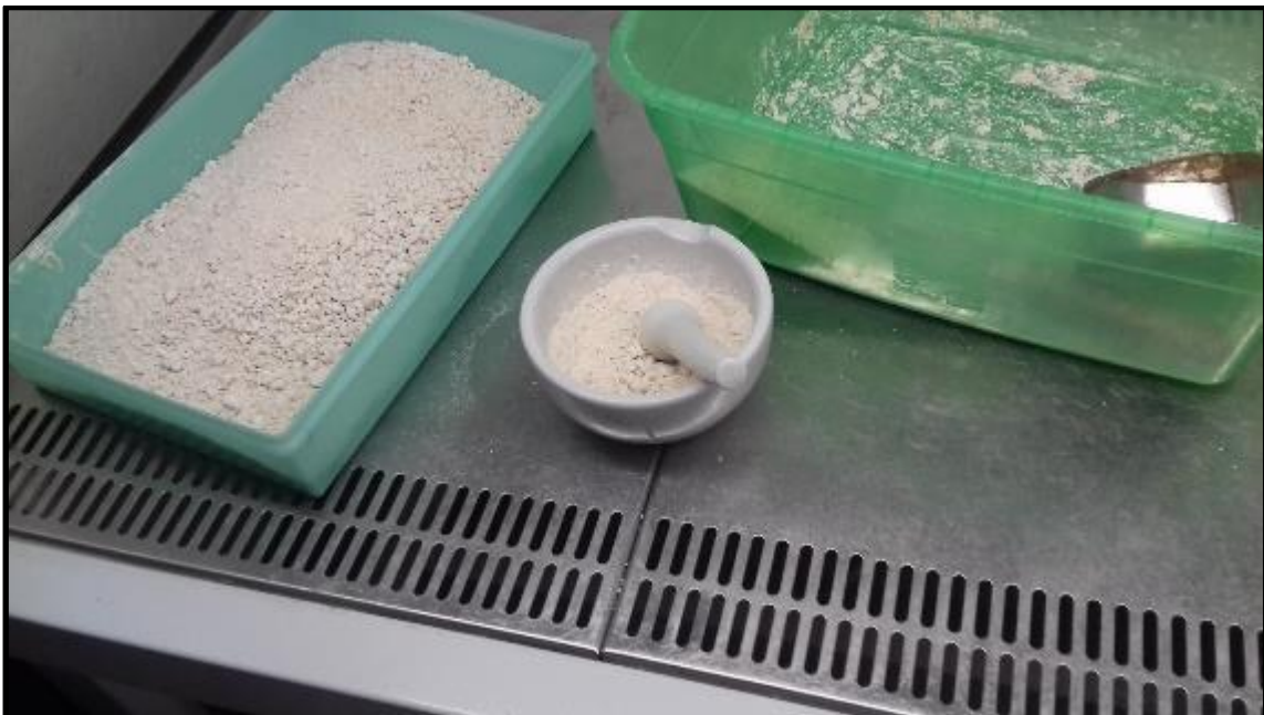
Figura 40. Triturado del sedimento con ayuda de un mortero y un tamiz fino en una campana de flujo laminar
