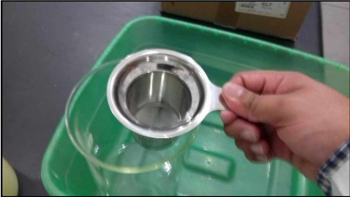
Figura 29. Filtro fino para impedir el paso de partículas finas como fragmentos de arroz y polvo
