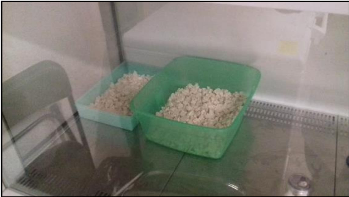
Figura 39. Secado del sedimento en una campana de flujo laminar por una semana
