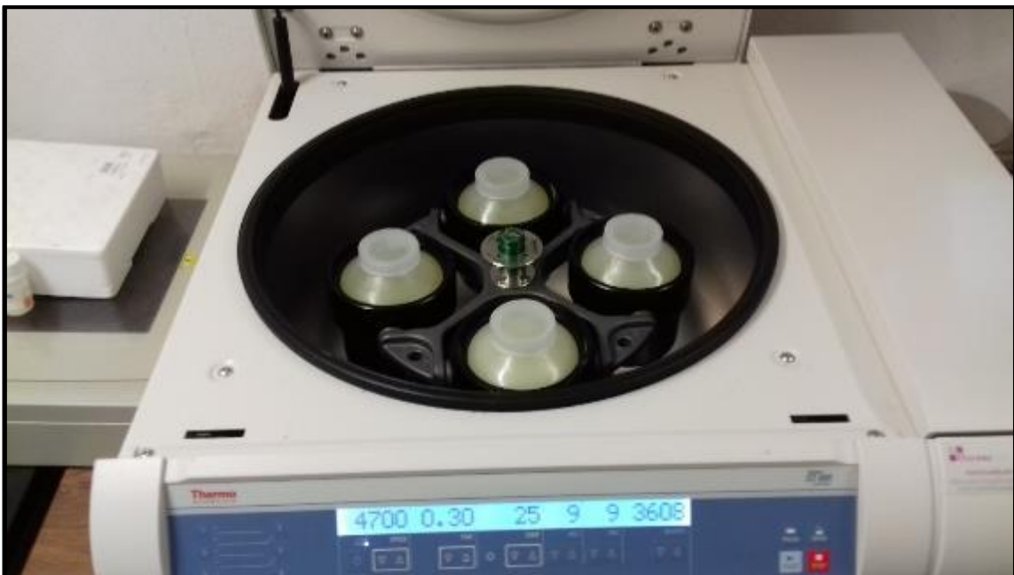
Figura 34. Centrifugado de los envases Thermo Scientific® para separar los conidios del líquido
