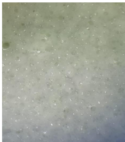
Figura 4.17. Interior de la PUF a presión atmosférica.
