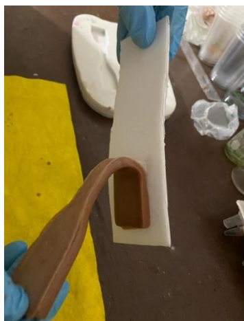
Figura 3.12 Remoción del compuesto.
