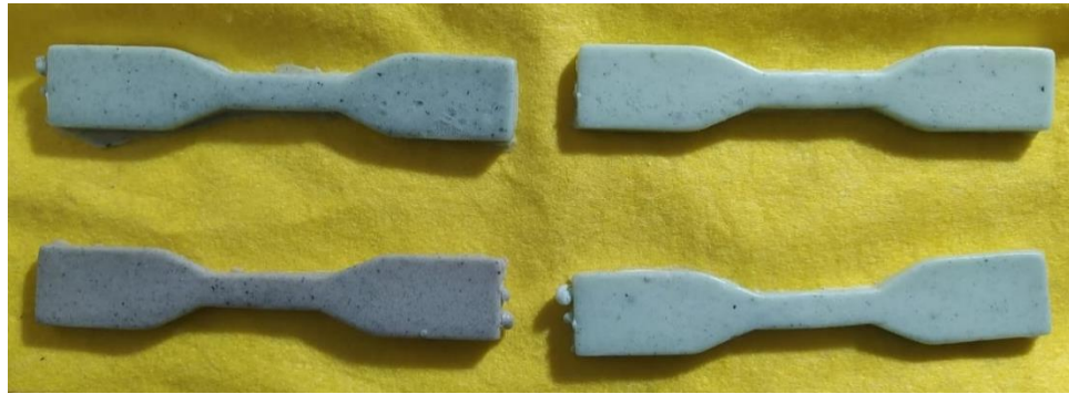
Figura 4.14. Compositos de Ferrita de níquel. Arriba izquierda al 0.5%, arriba derecha al 0.1%, abajo izquierda al 1.0%, abajo derecha al 0.3%.
