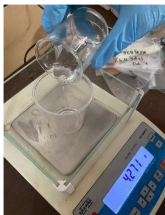
Figura 3.6. Medición de masa del polioliol.
