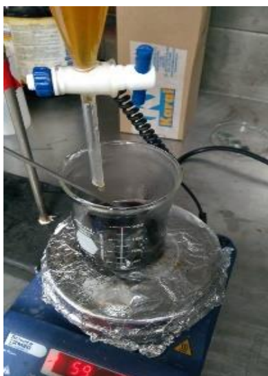
Figura 3.1. Síntesis de ferritas.
