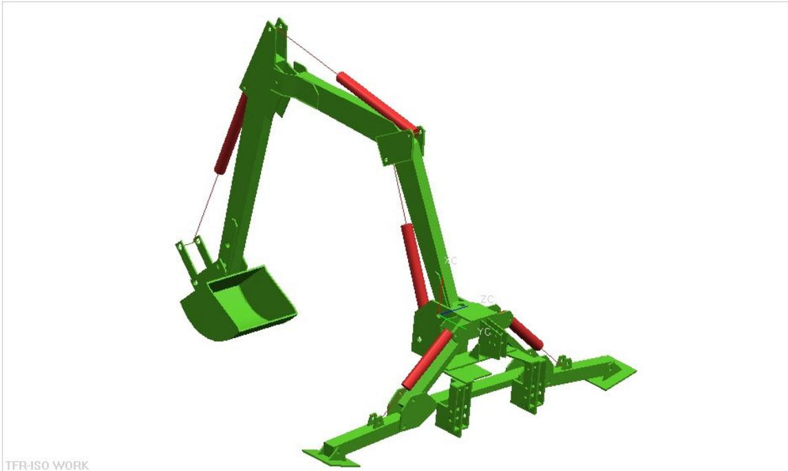
Fig.1.2. Representación de retroexcavadora Bison con sus 3 zonas de acoplamiento perforadas.
