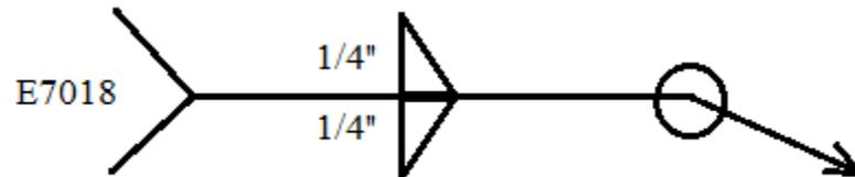
\* Fig. 7.6. Símbolo de soldadura a utilizar.
