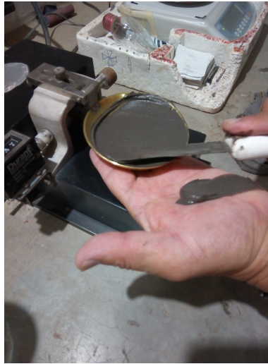
Figura 3. Concepto de plasticidad, copa de Casagrande
