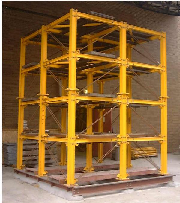
**Figura 4.2.** *Estructura de pruebas. Estructura real [37, 40].*
