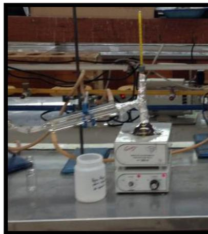
**Figura 3. 1.** Sistema de reacción, para la disolución parcial de la matriz silíceo del mineral.
