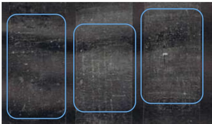
**Figura 64.** Cintas desprendidas de los ensayos de adherencia con granos y polvo de muestras de cantera gris (Compañía) consolidadas con brocha (arriba) y por aspersión (abajo).
