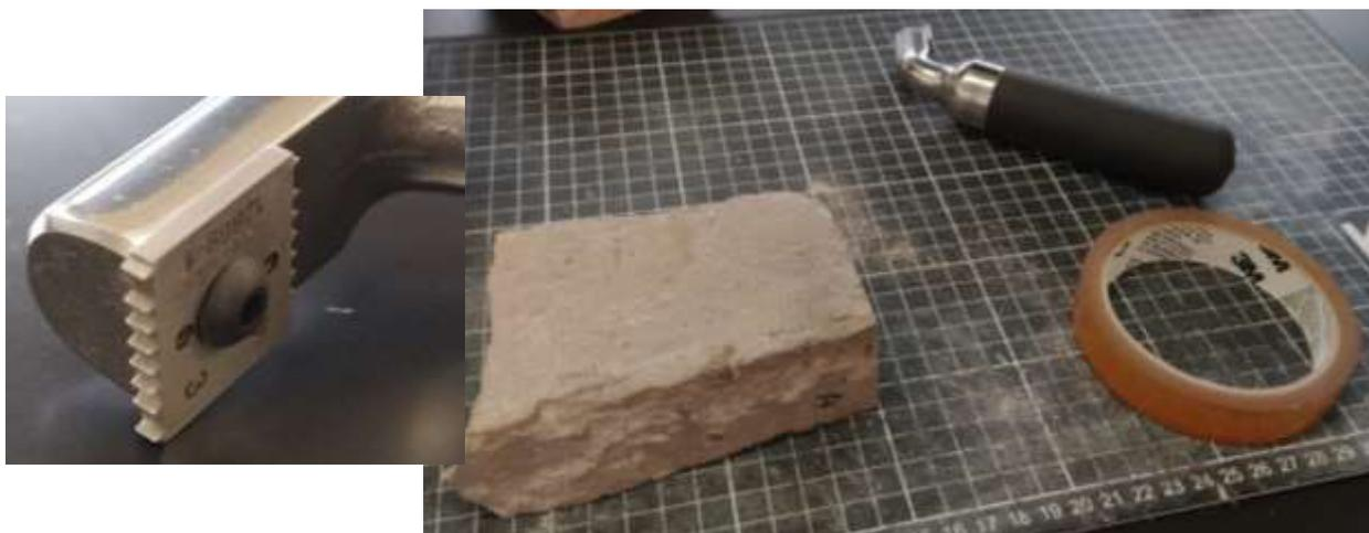
**Figura 24.** Cortador y cinta 3M empleados en la prueba de adherencia.
