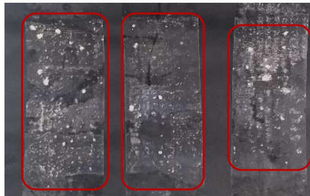
**Figura 90.** Cintas desprendidas de los ensayos de adherencia con granos y polvo de muestras de Caliche consolidadas con brocha (arriba) y por aspersión (abajo).
