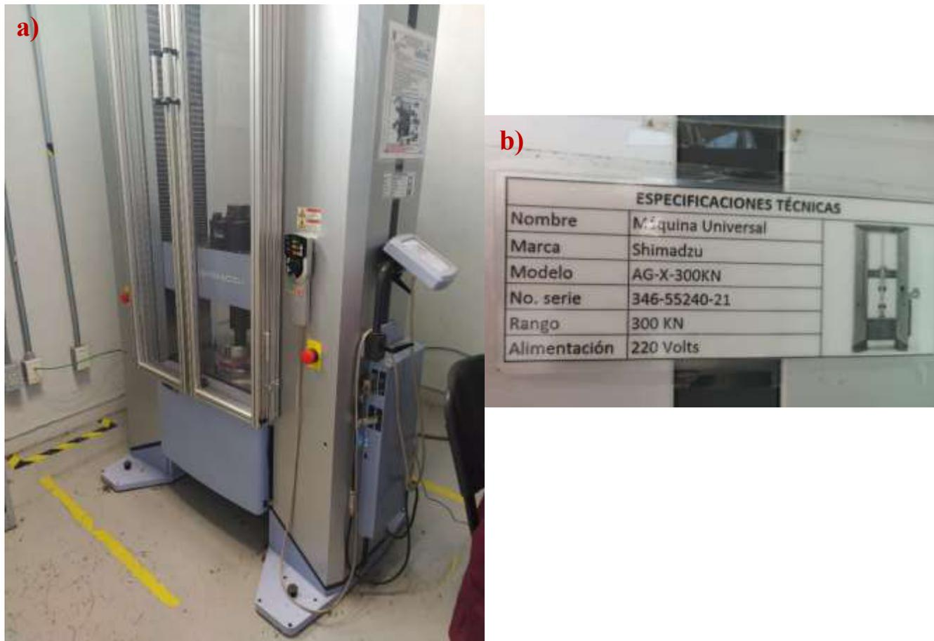
**Figura 28.** a) Equipo utilizado para las pruebas mecánicas de los materiales pétreos; b) Especificaciones.
