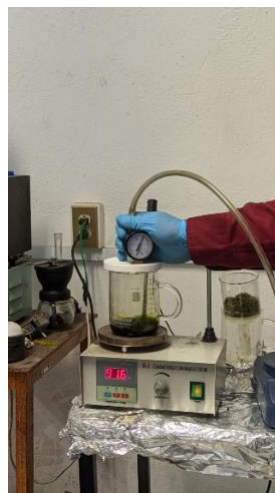
Figura 3. Montaje experimental para la extracción del aceite vegetal.
